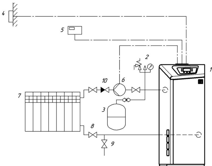
**Рис. 3. Примерная гидравлическая схема закрытой системы отопления с насосом\***
