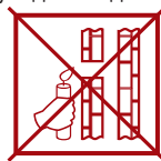
недостаточная тяга (Не используйте котел!)
