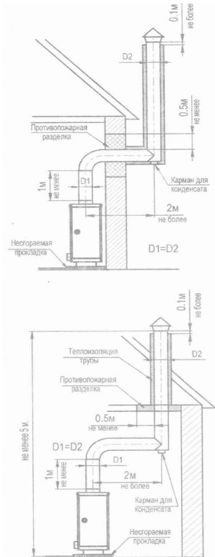
Рис. 12. Схема установки дымовой трубы с выводом через стену и с выводом через потолочное покрытие.
